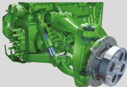
Eixo dianteiro com suspensão
