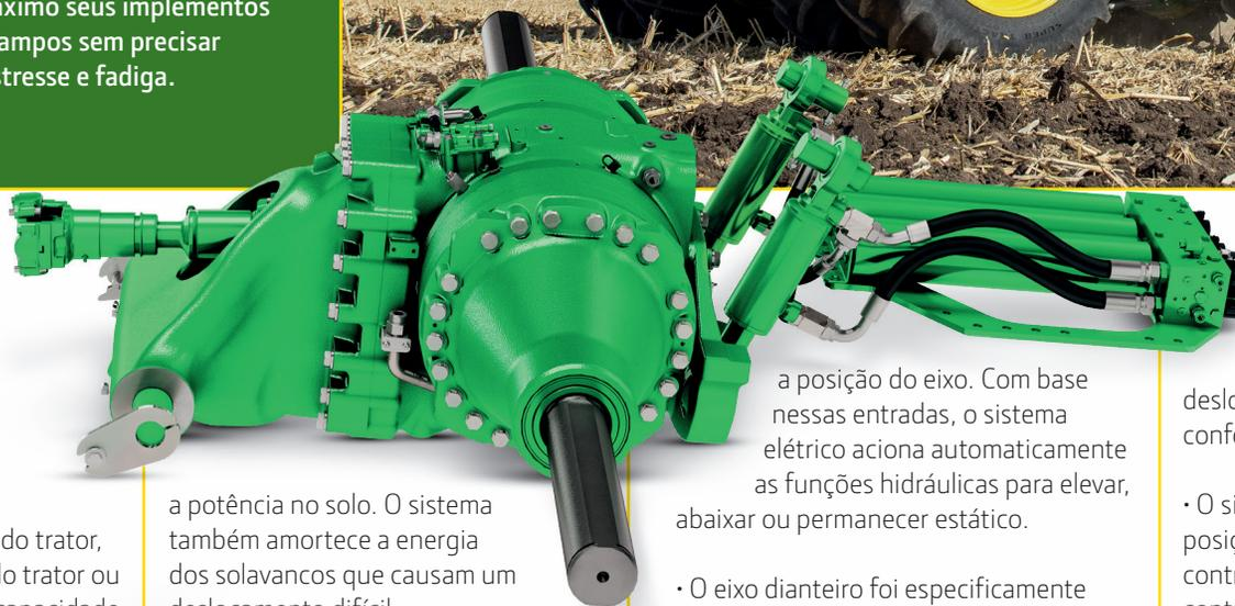
a potência no solo. O sistema também amortece a energia dos solavancos que causam um deslocamento difícil.
