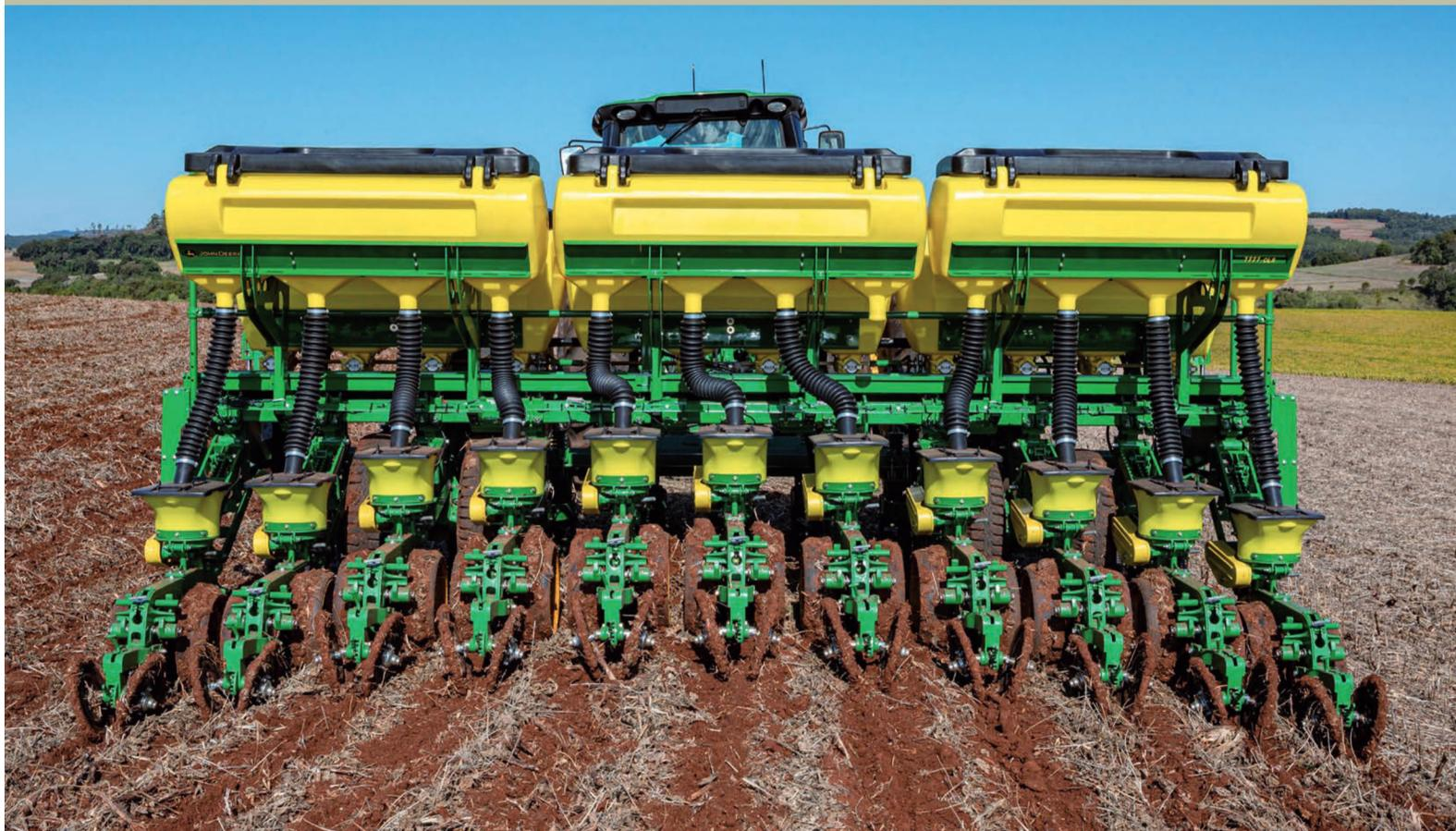
A CLS não interfere na força descendente exercida pela linha de plantio. Isto auxilia na manutenção dos níveis de pressão no decorrer de toda a operação.
