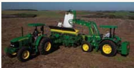
O Guincho Big-Bag GreenSystem™ BH1112G permite diminuir o tempo de carregamento de sua plantadeira, do distribuidor de sólidos ou de qualquer outro implemento, tornando o carregamento mais rápido e eficiente.
