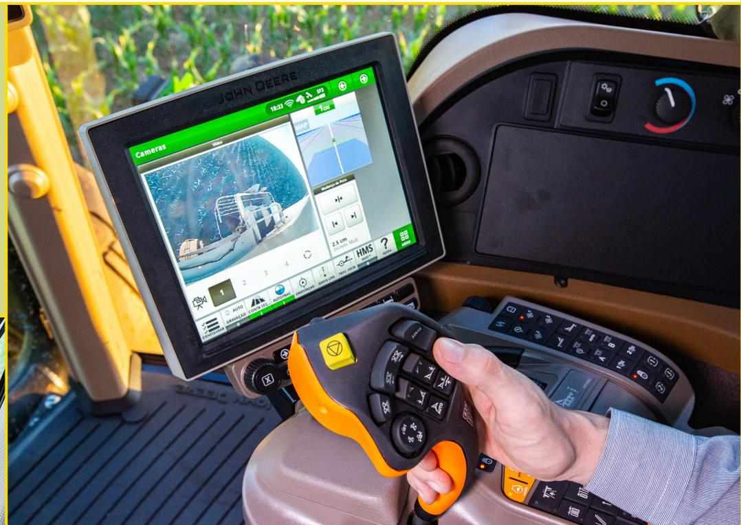
Os comandos de configuração, calibração e ajustes de dosagens são realizados da cabine, através do monitor Gen4 CommandCenter™. Além disso, o M4040DN vem equipado com Piloto Automático AutoTrac, Receptor Starfire™ 6000 e JDLink™. E ainda conta com opcionais: Data Sync, Controle de Seções e o Compartilhamento de Mapas de Campo.
