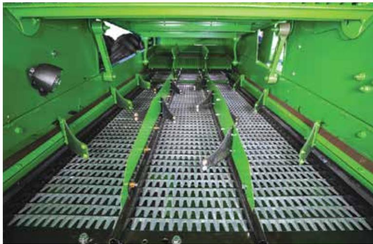
O ajuste automático ao terreno controla a abertura das peneiras e a velocidade do ventilador, ajustando-os automaticamente, de acordo com a inclinação da máquina, quando colhendo em subidas e descidas.
